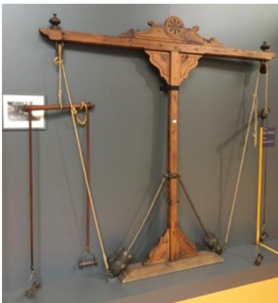
Estado final del aparato con las poleas y las 4 correas sustituidas
